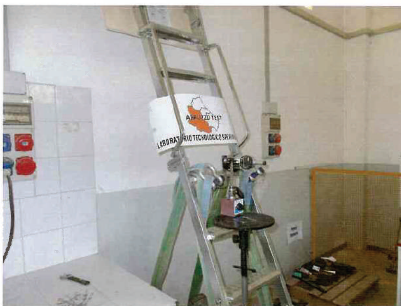
Foto 3: prova di carico statica – gradino cerniera centrale, particolare comparatore
