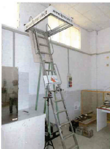
Foto 1: prova di carico statica – gradino cerniera superiore
