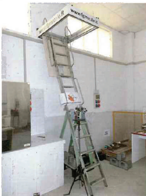
Foto 2: prova di carico statica – gradino cerniera centrale
